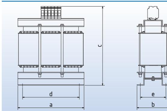
**Dreiphasen-Motordrosseln für Betrieb an Frequenzumrichtern nach VDE 0570 Teil 2-20, EN 61558-2-20**
