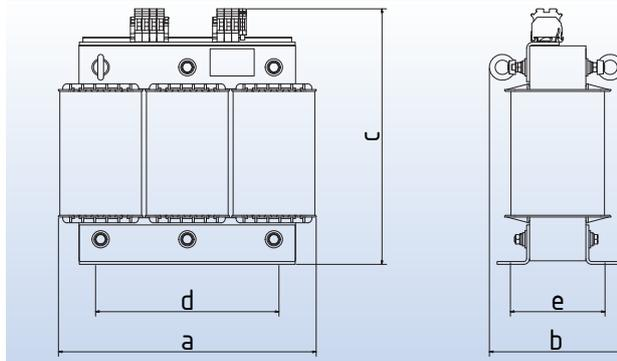
**Dreiphasen-Netztransformatoren nach VDE 0570 Teil 2-1, EN 61558-2-1**
