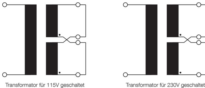
Bei mehreren Sekundärspannungen wird die Nennsekundär – Stromstärke aus der höchsten Sekundärspannung errechnet. Die Anzapfungen können daher nur mit der aus Leistung und höchster Sekundärspannung errechneten Stromstärke belastet werden.
