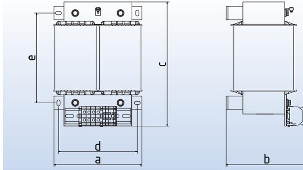
**Einphasen-Steuertransformatoren nach VDE 0570 Teil 2-2, EN 61558-2-2**
