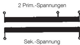
Weiterer Wickelraumbedarf tritt ebenfalls nicht ein, wenn eine zweite Primärspannung halbiert die erste ergibt (z. B. 115V – 230V).
