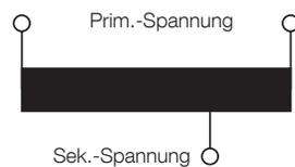
Anstelle eines Transformators der Baugröße für 1000VA wird also nur ein solcher der Baugröße 425VA benötigt.
