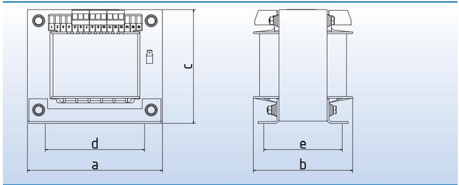
**Einphasen-Steuertransformatoren nach VDE 0570 Teil 2-2, EN 61558-2-2**
