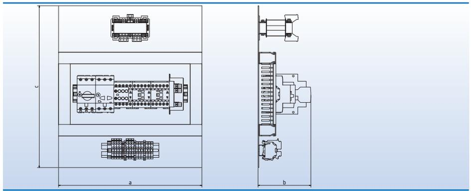
**Vormagnetisierungseinheit zur Vermeidung von Einschaltstoßströmen**
