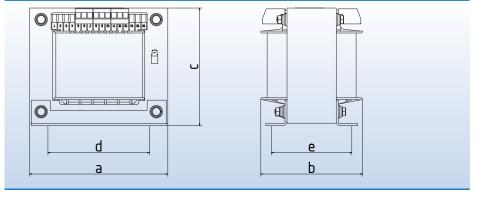
Einphasen-Steuertransformatoren nach VDE 0570 Teil 2-2, EN 61558-2-2
